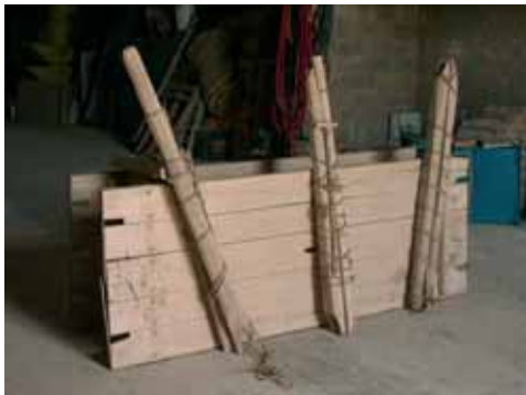
Fig 18.1 (arriba). Conjunto de tapiales, frontera y tres pares de costeros con sus correspondientes agujas liados con cuerdas para su almacenamiento (Juan Soriano, Pozocañada)
