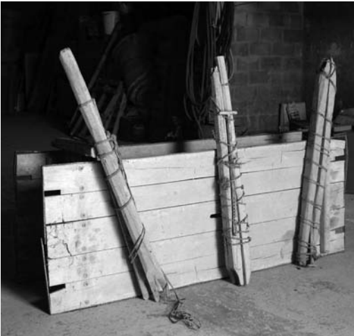
Figura 11 Conjunto de tapiales, frontera y tres pares de costeros con sus correspondientes agujas liados con cuerdas para su almacenamiento (Juan Soriano, Pozocañada)
