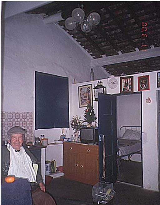
Fig.8 – Habitação com duas alcovas separadas da divisão principal por tabiques em Alcácer do Sal . Concelho de Alcácer do Sal .
